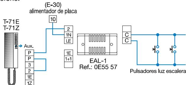
5 · Encendido luz de escalera mediante activación del abrepuertas.
