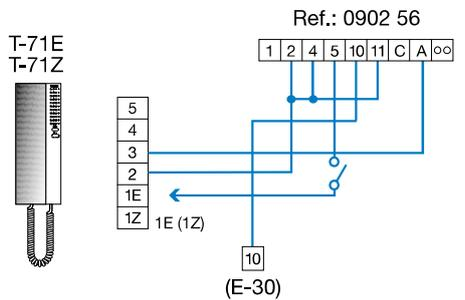
Se precisa un módulo accionador automático de abrepuertas (Ref.: 0902 56) que no se puede alojar en el interior del teléfono. Incorporar interruptor para activar-desactivar el sistema.
