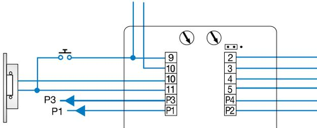
2 · Accionamiento automático del abrepuertas mediante el pulsador de llamada en placa.
